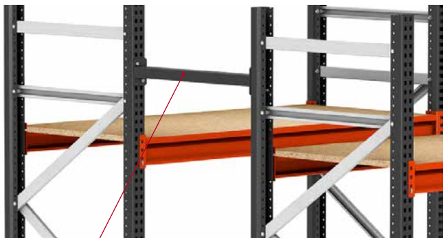
Frame afstandhouder DC50 Verbindingselement dat is vastgeschroefd aan twee jukken die op hetzelfde niveau zijn geplaatst. Dit om een constante afstand tussen twee uitgelijnde modules te behouden. AFWERKING → Gegalvaniseerd
