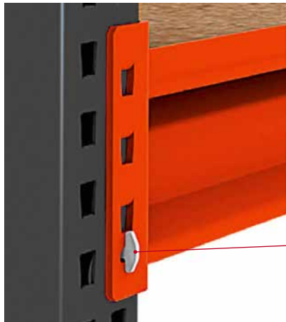
Veiligheidsclip CRM Element ontworpen om de liggers aan de staanders te vergrendelen. AFWERKING → Gegalvaniseerd
